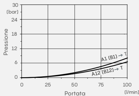
Perdita di carico A(B)→T
